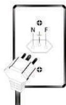
Figura 3: Plug modelo nacional com fio terra
