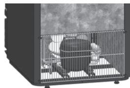
Figura 12: Acesso a unidade condensadora pela traseira
