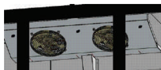
Figura 12: Imagem interna do evaporador e forçador Visa Cooler Extra Frio 3 portas
