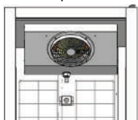
Figura 10: Imagem interna evaporador e forçador Visa Cooler Gela Canecas.
